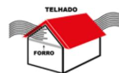
Instale-o somente em locais que apresentem condições adequadas de ventilação entre o forro e o telhado.
