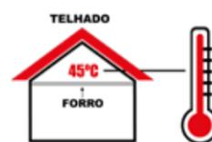
Cuidado com o calor, o forro de PVC rígido suporta, no máximo, 45°C sem que haja deformação.
