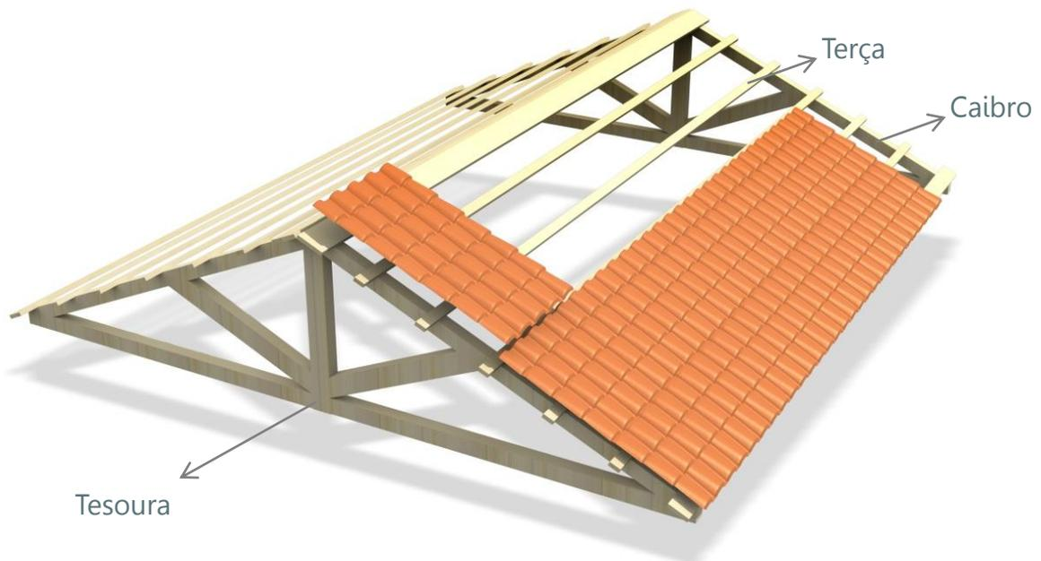
**Obs.:** Para a instalação das telhas em PVC Permitti não se deve utilizar ripas na estrutura do telhado. As telhas Permitti alcançam maiores vãos, demandando menores peças de apoio do que telhas convencionais.
